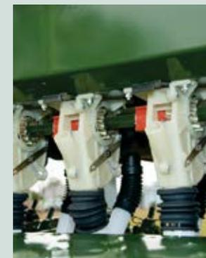
Distribuição de semente por rotor helicoidal em aço.
