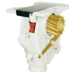
Distribuição de semente por meio da caixinha dosadora com rotor helicoidal em aço.
