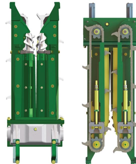
Linha colhedora com caixa de transmissão em alumínio e lubrificação a óleo. Rolos recolhedores com aletas removíveis. Sistema eficaz de limpeza nos rolos, com navalhas em aço temperado e com fio.
