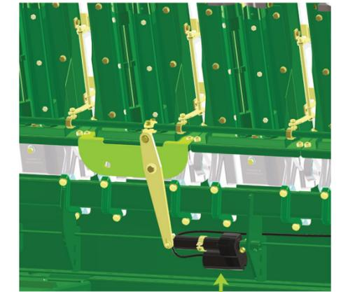
Sistema elétrico de regulagem da abertura das chapas por meio de atuador e controle remoto sem-fio ficando sempre ao alcance do operador (opcional).
