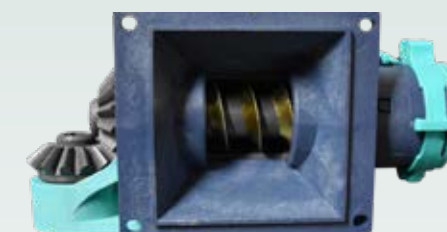
Distribuição de adubo no sistema rosca sem-fim.
