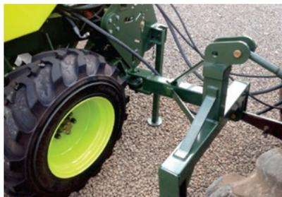
Acoplamento ao trator por meio de levante três pontos.
