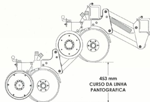
Ótima pantografia de linhas, o que proporciona um excelente plantio em terrenos desnivelados.
